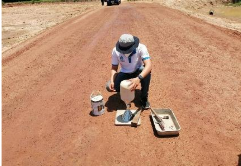
รูปที่ 1.7-3 งานทดสอบดินทรายถมหลังท่อ
